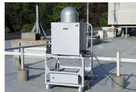
可搬型モニタリングポスト (バッテリー付)【18台】
