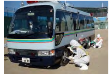
(写真 6-2) 放射線測定器による検査（車両）
