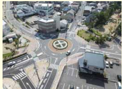
ラウンドアバウト構造を持つ平面交差点 （長野県飯田市の東和町交差点）
